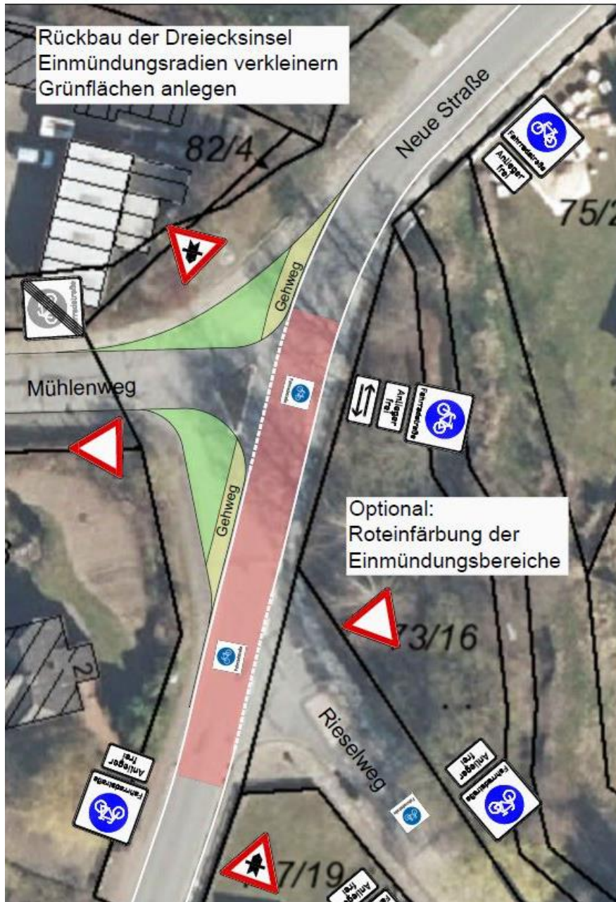
Abb. 13: Vorschlag zum Rückbau des Einmündungsbereichs des Mühlenweges
