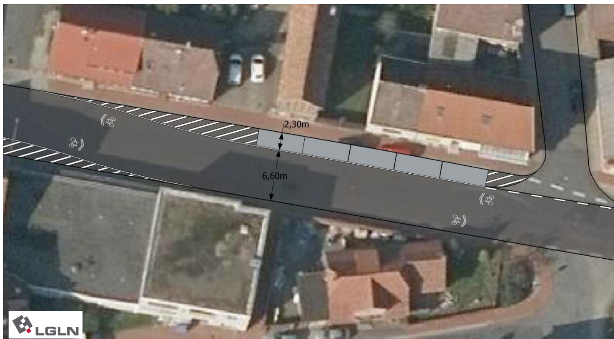
Abb. 23: Skizze 1: Piktogrammketten und abwechselnd einseitiges Parken in der Ortsmitte (zwischen Einmündung Emmastraße/Kreuzstraße und Am Schützenplatz/Alte Siedlung)
